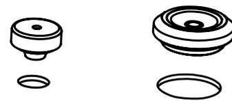
6. Schrauben Sie die Leuchte an die Decke (der EPDM-Gummi der Unterlegscheibe sollte wie in der Zeichnung gezeigt zum Leuchtenkörper zeigen), und schieben Sie dabei die Stromversorgungskabel durch die Tüllen. Denken Sie daran, dass Kabelmäntel über die Tülle hinausragen sollten.
